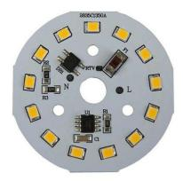
Si on regroupe plusieurs LED montée en série, on pourra augmenter la tension d'alimentation globale. Par exemple avec 30 LED rouges, dont le seuil est d'environ 1,8 v, qui sont montées en série, on pourra les alimenter en 54 volts, ce qui va simplifier le circuit de commande.
